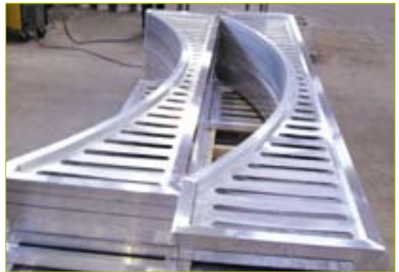
Tôle poinçonnée soudée sur cadre aluminium.
